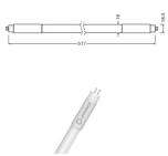
Scheda tecnica Ledvance Tubo LED T5 Value Short (HF) High Efficiency 7W 850lm - 840 Bianco Freddo | 52cm - Sostitutiva 13W
